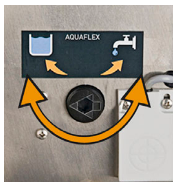
Śruba nastawcza znajduje się za pojemnikiem na wodę pitną.
