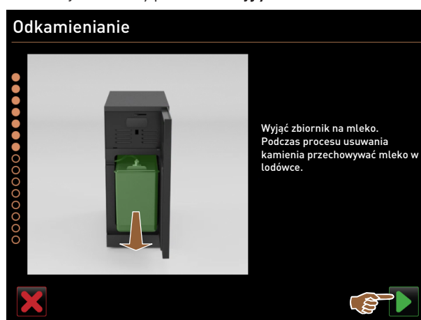
Rys. 174: Wyjmowanie zbiornika na mleko
