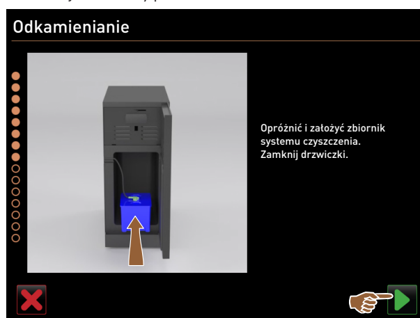
Rys. 175: Wstawianie zbiornika systemu czyszczenia
