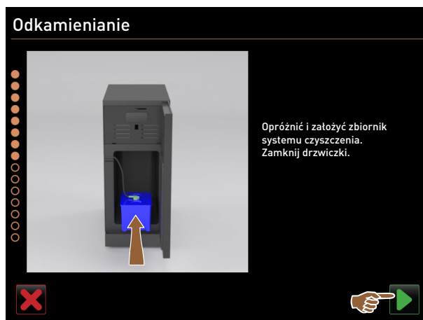
Rys. 190: Wstawianie zbiornika systemu czyszczenia
