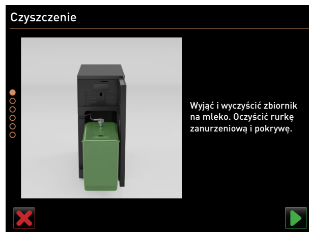
Rys. 112: Wyjmowanie zbiornika na mleko
