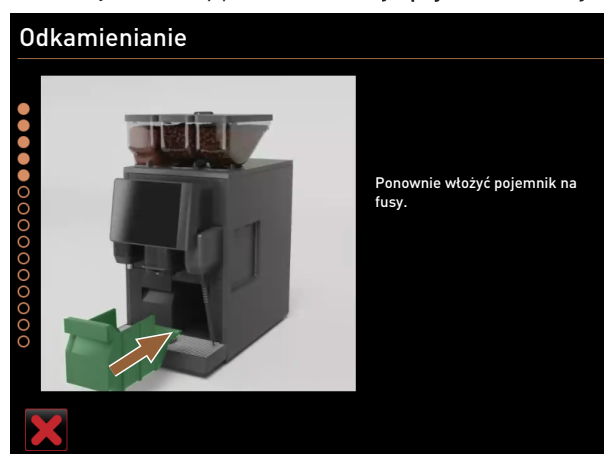
Rys. 187: Wkładanie pojemnika na fusy
