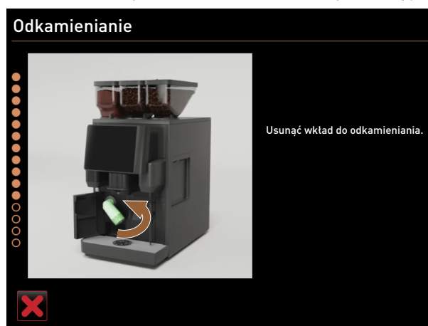
Rys. 179: Usuwanie wkładu do odkamieniania
