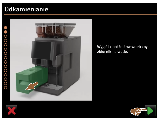
Rys. 184: Wyjąć i opróżnić zbiornik na wodę.
